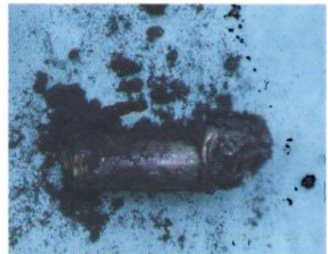
火災の原因と判定されたリチウムイオン電池の残骸
